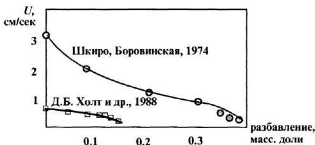
Рис. 5. Зависимость скорости горения Ti+C от разбавления конечным продуктом
