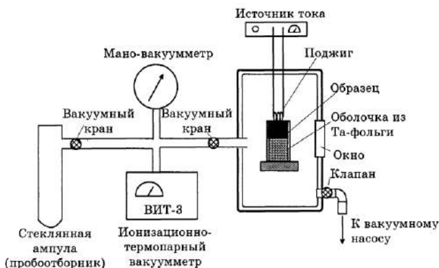
Рис. 27. Схема установки для исследования примесного газовыделения при СВС
