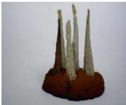
Рис. 64. Определение огнеупорности композиционных материалов
