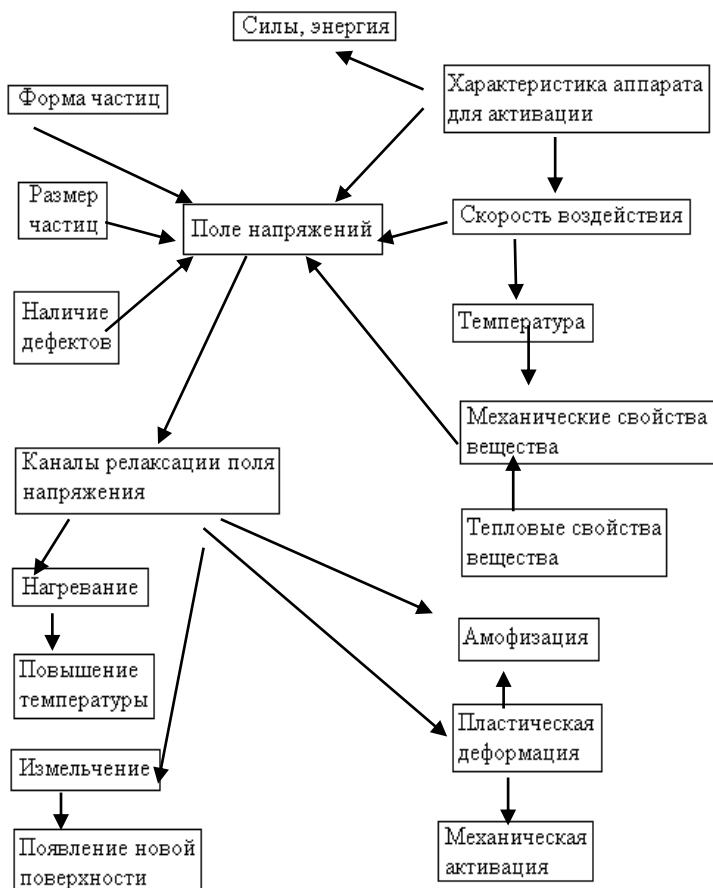
Рис. 52. Факторы, влияющие на формирование поля напряжений, и основные каналы релаксации напряжений
