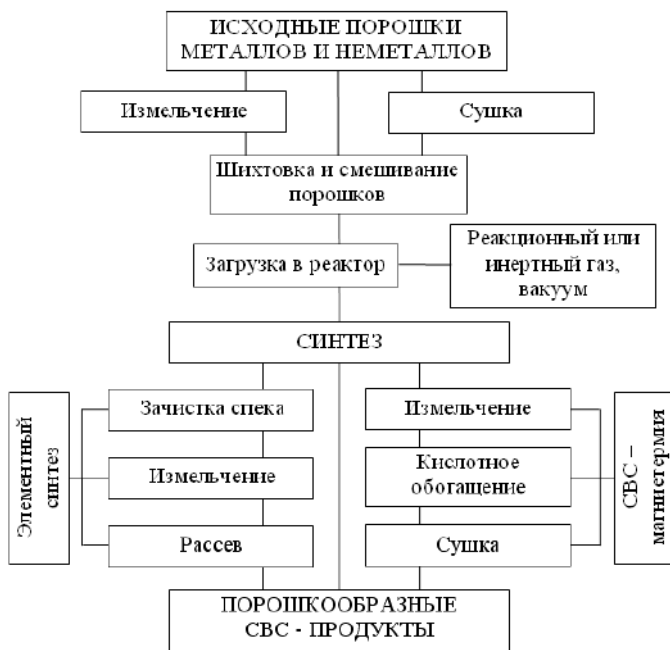
Рис. 35. Схема СВС-технологии производства порошков
