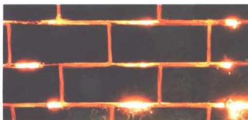
Рис. 54. Фурнон для футеровки металлургических печей
