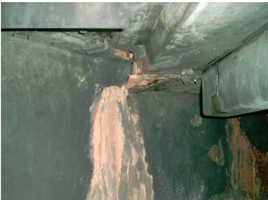
Рис. 3.10. Коррозионный износ места слива насыщенного раствора ДЭА в абсорбере
