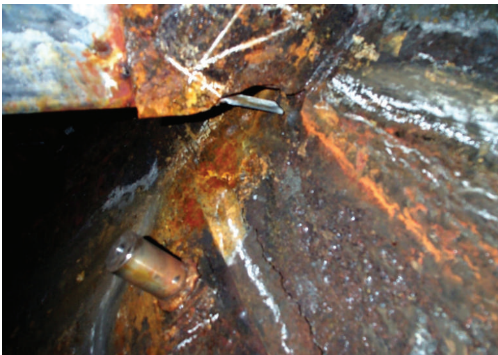
Рис. 4.2. Коррозия обечайки внутри абсорбера
