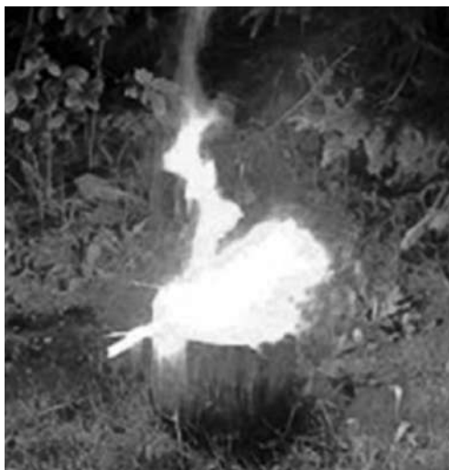
Рис. 3.13. Горение пиррофорного железа в естественных условиях
