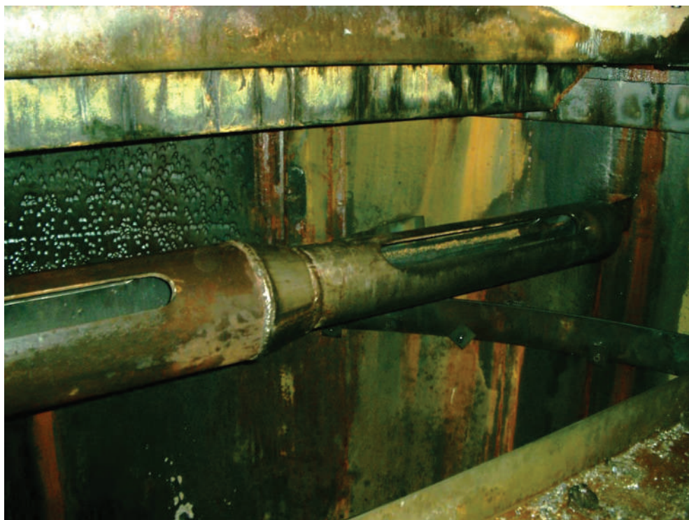
Рис. 3.8. Точечная коррозия на обечайке абсорбера очистки газов от кислых компонентов
