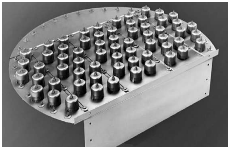
Рис. 2.39. Внешний вид колпачковой тарелки
