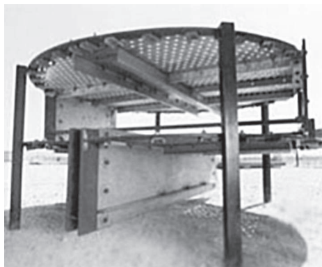
Рис. 2.26. Внешний вид ситчатых тарелок
