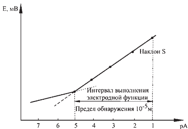
Рис. 6. Интервал выполнения электродной функции и предел обнаружения ион-селективного электрода
