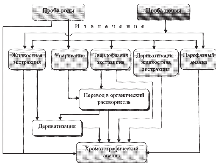
Рис. 30. Основные этапы методических подходов, используемых при разработке способов количественного химического анализа соединений в пробах объектов окружающей среды
