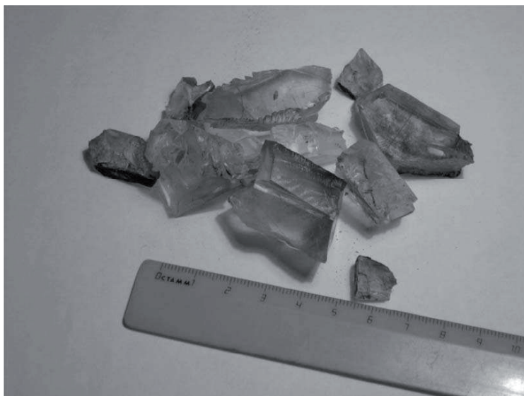
Рисунок 3.5. Испытуемый образец после взрыва
