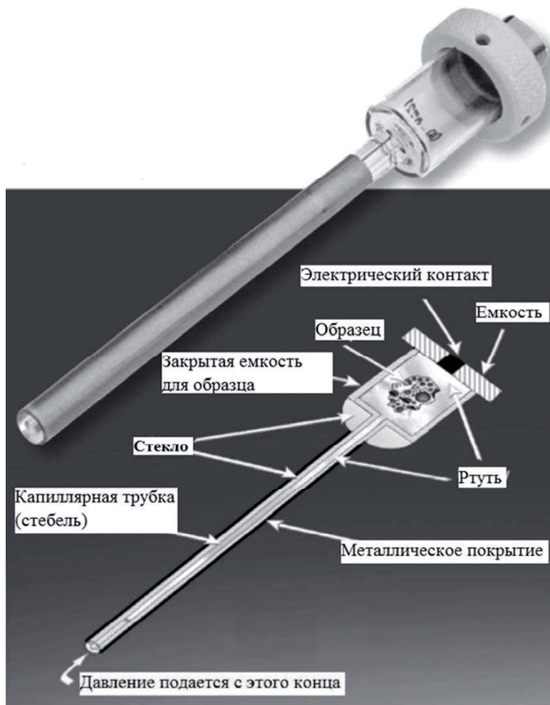
Рисунок 6.15. Внешний вид, поперечное сечение и характер заполнения ртутного пенетromетра [21]
