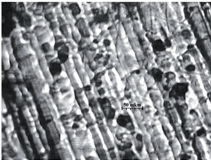
Рисунок 3.7. Электронно-микроскопический снимок образца полиэтилена (ПЭ) после взрыва. Метод анализа: прерывисто-контактная атомно-силовая микроскопия, оптическая микроскопия, тип прибора: сканирующий зондовый микроскоп MultiMode-V фирмы Veeco. Методика съемок: препараты приготовлены фиксацией пробы на металлической подложке специальным фиксирующим клеем.
