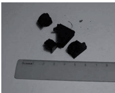
Рисунок 3.4. Испытуемый образец после взрыва
