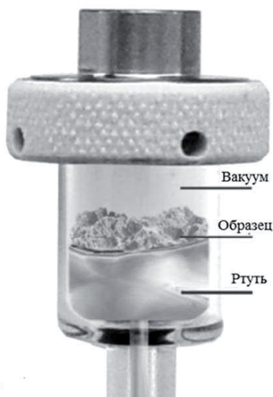
Рисунок 6.16. Иллюстрация, заполнения ртутью, запечатанной чашки для образца, с настоящим образцом [21]
