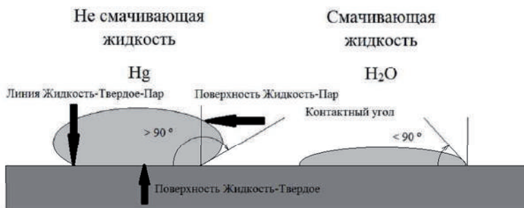
Рисунок 6.14. Сечение капли жидкости, покоящиеся на твердой поверхности жидкости. Для не смачивающей жидкости показаны все межфазные поверхности.
