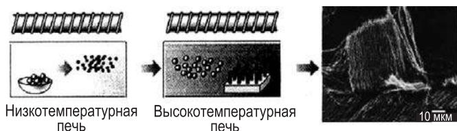
Рис. 2.19. Схема получения углеродных НТ методом крекинга углеводородов
