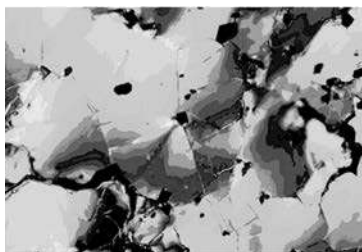
Рис. 8.34. Микрофотография поверхности сверхпроводящей композиционной ленты на основе Bi-2223 с наноразмерными добавками \text{TiO}_2(800^\circ\text{C})
