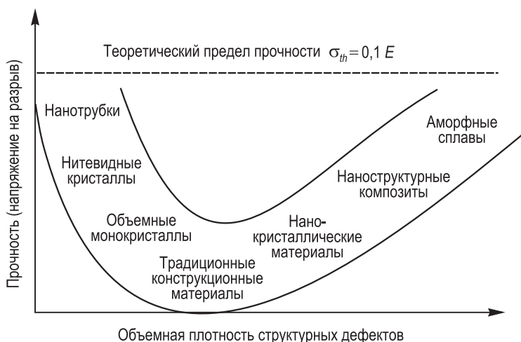
Рис. 4.7. Схематическая зависимость прочности материалов от концентрации атомарных дефектов, демонстрирующая два принципиально возможных пути улучшения прочностных характеристик: за счет уменьшения и за счет увеличения количества дефектов структуры
