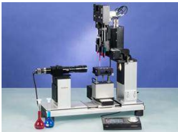
Рис. 4.8 Оптический прибор ОСА 200 для измерения краевого угла смачивания
