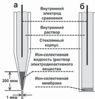
Рис. 1-5. Ионоселективные электроды. а – микроэлектрод с жидкой мембраной, б – мембранный макроэлектрод.
