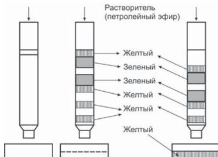
Рис.2-1. Схематичное представление хроматографических экспериментов, выполненных М.С. Цветом.
