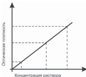
Рис.4-7. Зависимость оптической плотности от концентрации раствора
