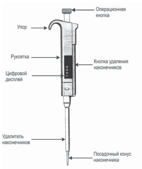
Рис.7-1. Внешний вид автоматического дозатора.
