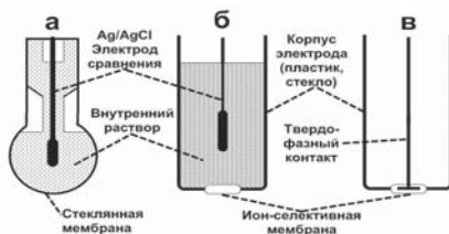
Рис.1-6. Конструкция ионоселективных электродов.
