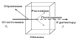
Рис.4-2. Потеря интенсивности излучения при прохождении через образец.
