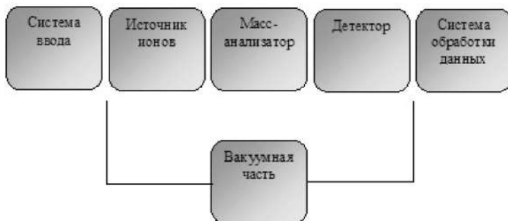
Рис.2-1. Принципиальная схема масс-спектрометра.
