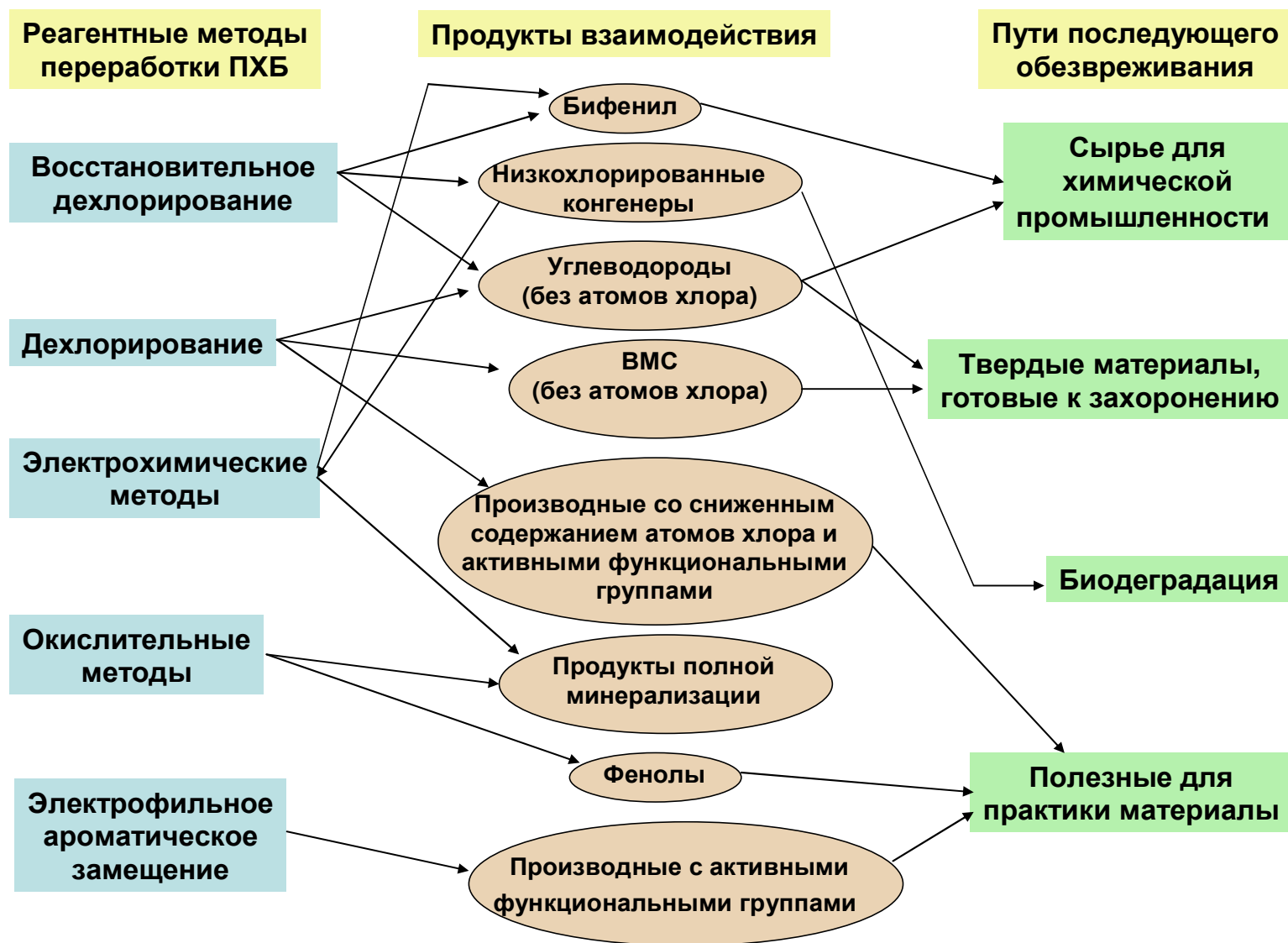
Рис. 1.1. Взаимосвязь методов обезвреживания полихлорбифенилов, результирующих продуктов и потенциальных путей их использования.
