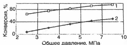
Рисунок 4.5. Влияние общего давления на глубину обессеривания (1) и деазотирования (2) вакуумного дистиллята – фракции 350-560°C (объемная скорость подачи сырья 1 \text{ ч}^{-1} , температура 380°C, кратность циркуляции ВСГ 500 \text{ м}^3/\text{м}^3 )
