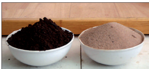
Рис. 4.25. Исходный шлам Малореченского месторождения и после отмыва и биодеструкции.
