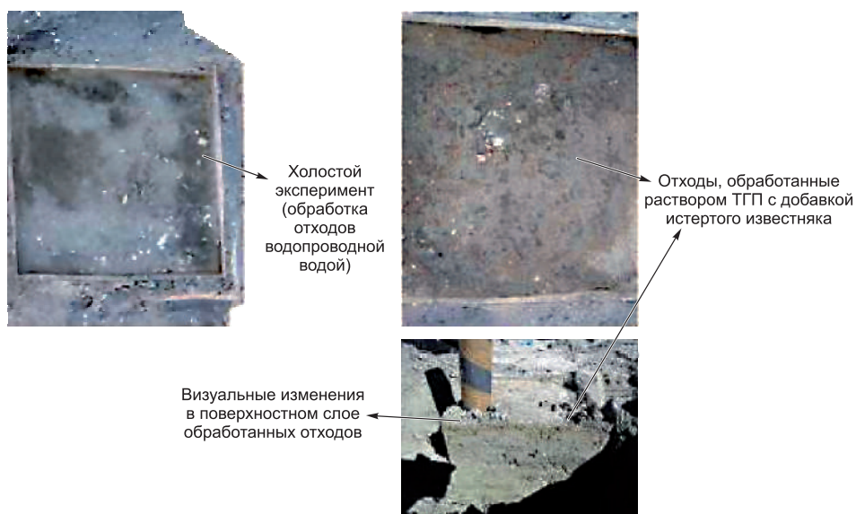
Рис. 3.14. Эксперимент по предотвращению пыления отходов.
