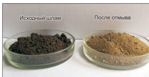
Рис. 4.7. Исходный нефтешлам и после отмыва композицией и водой.
