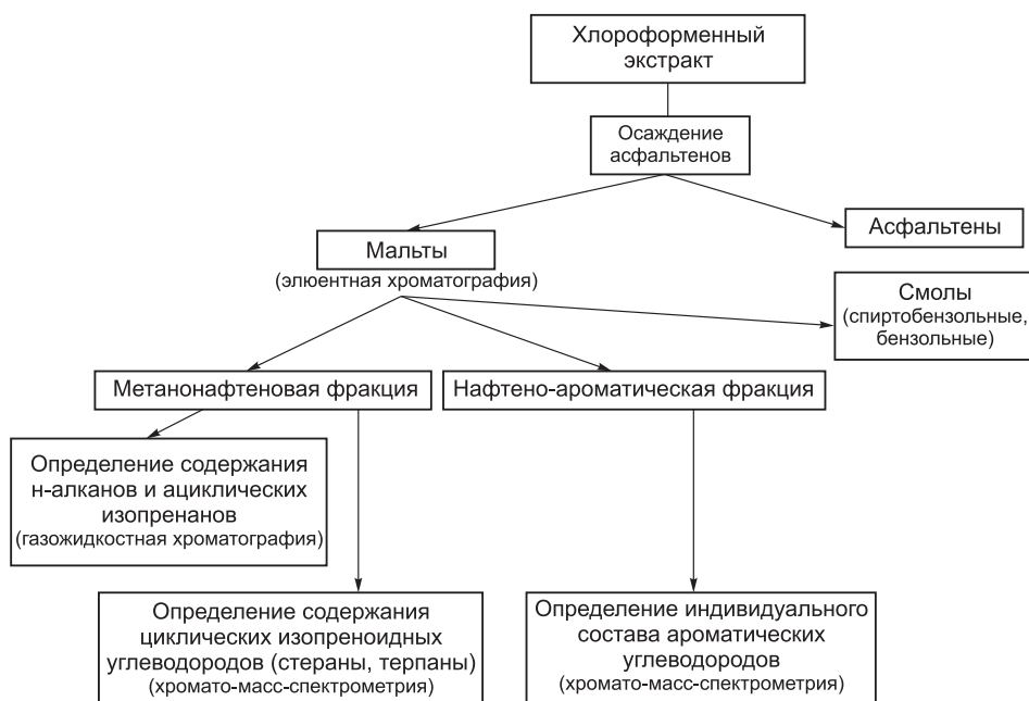
Рис. 4.4. Схема подготовки и исследования хлороформенных экстрактов.
