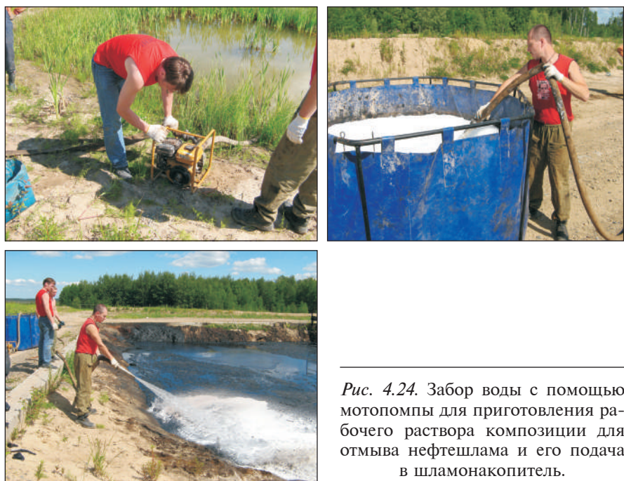
Рис. 4.23. Установка специальной емкости для приготовления рабочего раствора моющей композиции.
