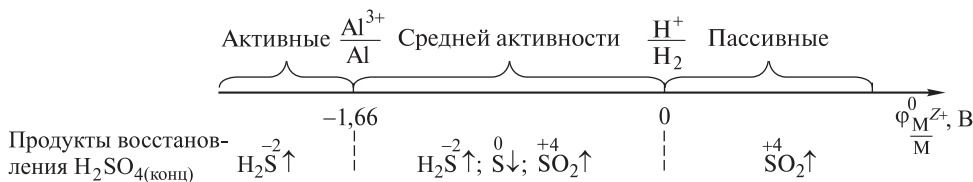
Рис. 7.2. Схема, иллюстрирующая соответствие между активностью металла и преобладающим продуктом восстановления молекул \text{H}_2\text{SO}_4 в ее концентрированных растворах
