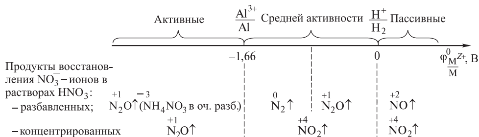
Рис. 7.3. Схема, иллюстрирующая соответствие между активностью металла и преобладающим продуктом восстановления ионов \text{NO}_3^- в разбавленных и концентрированных растворах \text{HNO}_3
