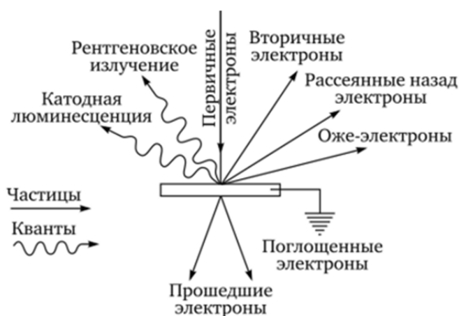
Рис. 18. Виды сигналов, детектируемых в системах СЭМ
