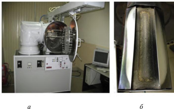
Рис. 16. Устройство для высокочастотного магнетронного распыления: а – установка; б – электрод
