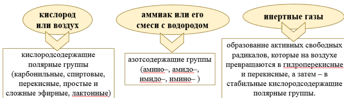
Рис. 12. Образование функциональных групп вследствие плазменной обработки
