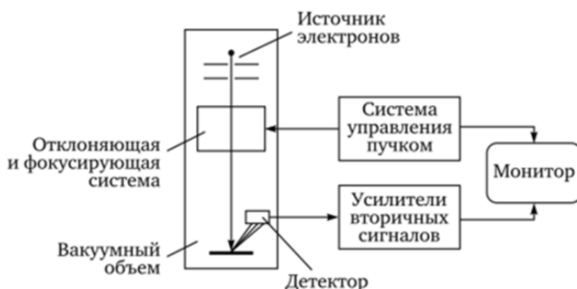
Рис. 17. Принципиальная схема устройства сканирующего электронного микроскопа
