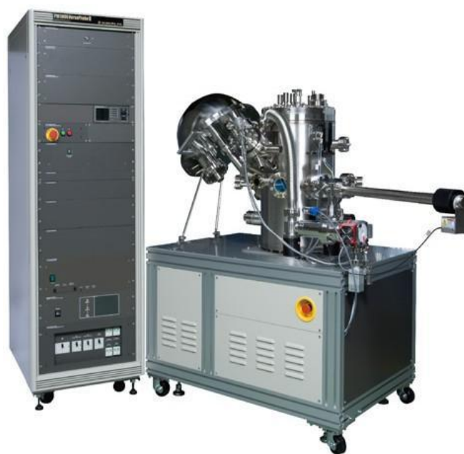
Рис. 49. Электронный спектрометр PHI X-tool automated XPS microprobe
