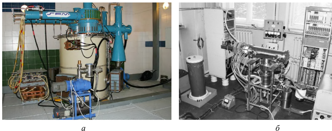
Рис. 6. Ионно-лучевые ускорители: а – ИЛУ-10; б – Везувий-1
