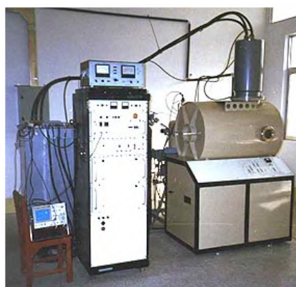
Рис. 7. Ионный источник «Титан»
