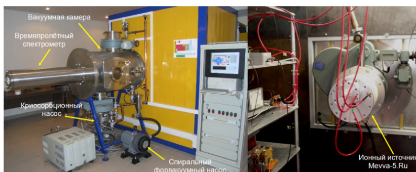
Рис. 9. Ионный источник MEVVA-5.Ru
