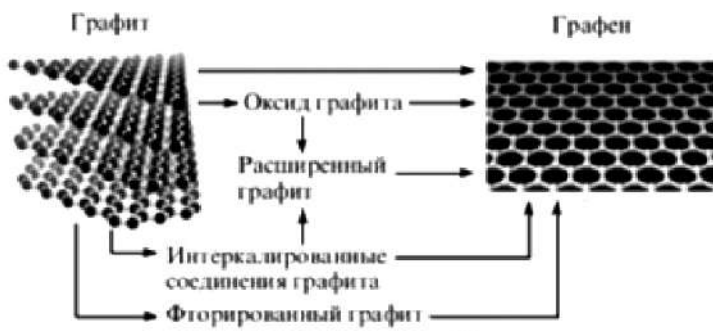
Рис. 3. Схема получения графена из графита [84]
