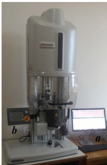
Капиллярный реометр CEAST MF50 фирмы INSTRON: а) компьютерное управление и б) ручное управление
