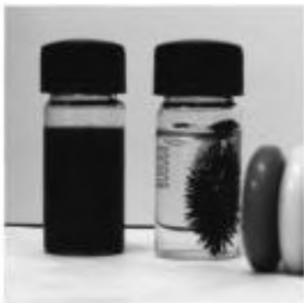
Рис. 5.7. Отделение ферромагнитных наночастиц катализатора с помощью магнита
