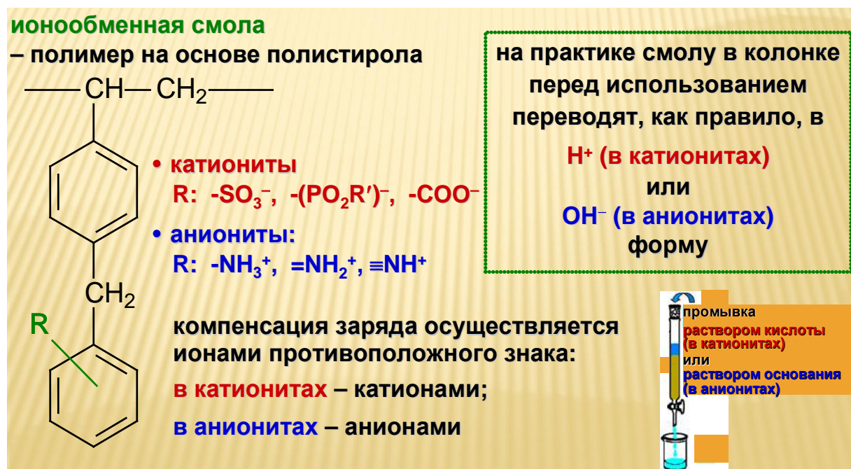
Рис. 7.3. Структура молекулы ионообменной смолы
