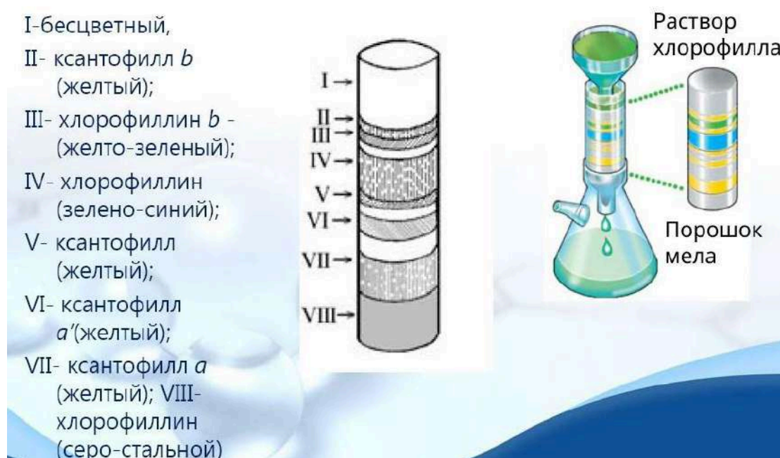
Рис. 1.2. Разделение раствора хлорофилла
