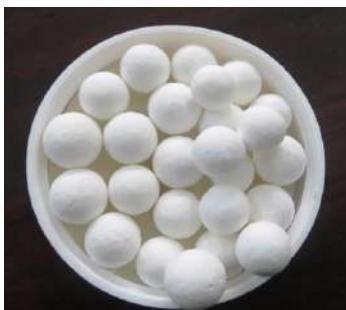
Рис. 21. Платиновый катализатор на активном оксиде алюминия в виде шариков
