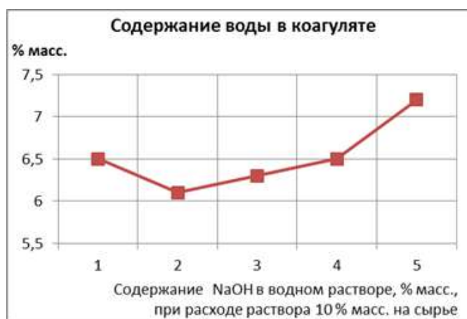
Рис. 4.5. Зависимость содержания воды в коагуляте от концентрации коагулянта
