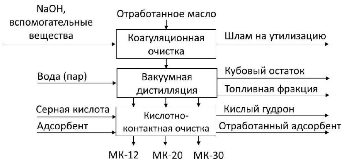
Рис. 3.6. Блок-схема ООО «РЗ-СМ»
