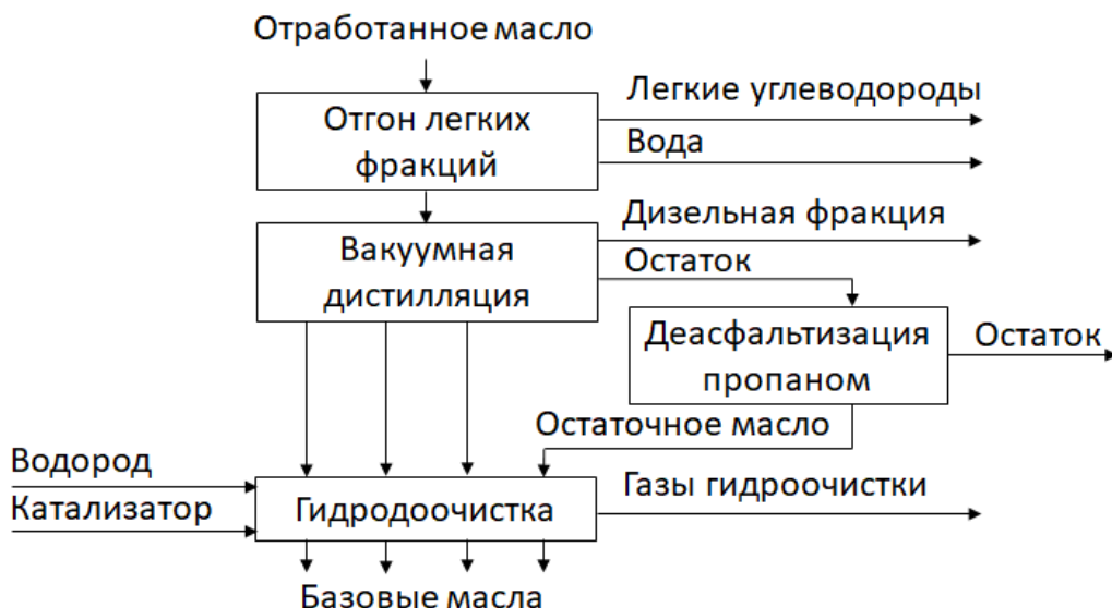
Рис. 3.4. Схема Revivoil заводов компании Viscolube (Италия)
