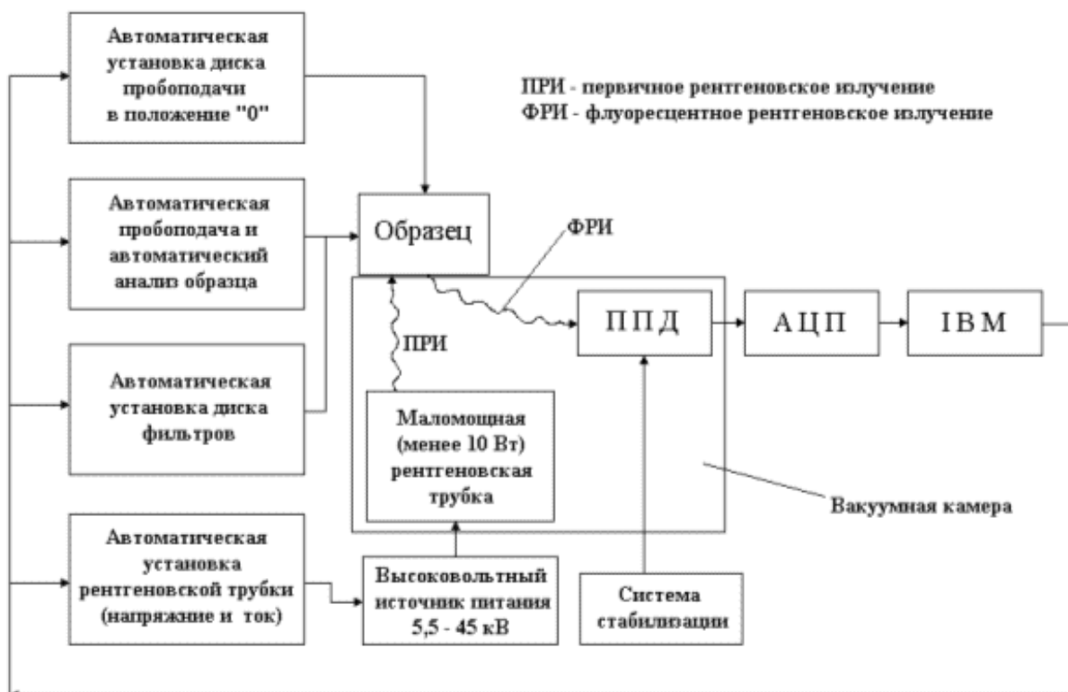
Рис. 5.3. Функциональная схема БРА-18
