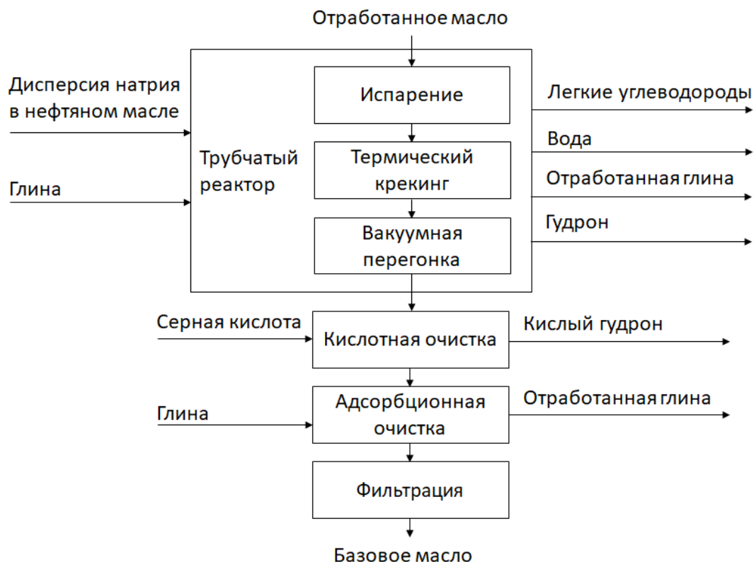
Рис. 3.5. Схема технологии ENTRA компании ENTRA
