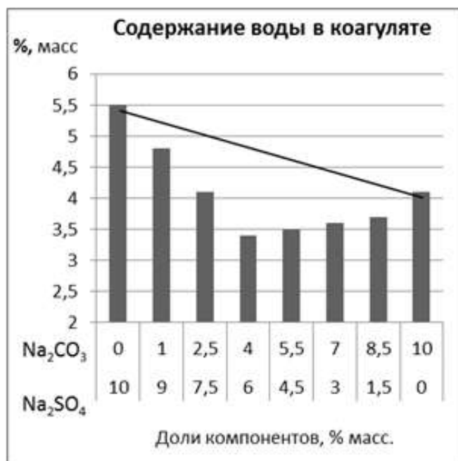
Рис. 4.9. Синергетическое действие компонентов композиции
