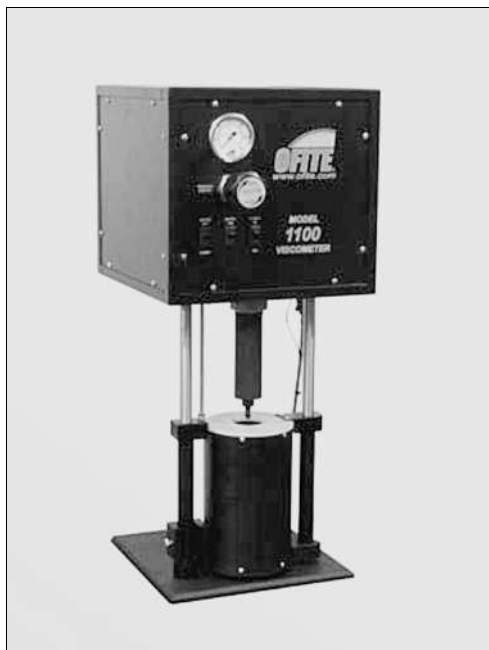
Рис. 4.13. Вискозиметр высокого давления и температуры OFITE 1100
