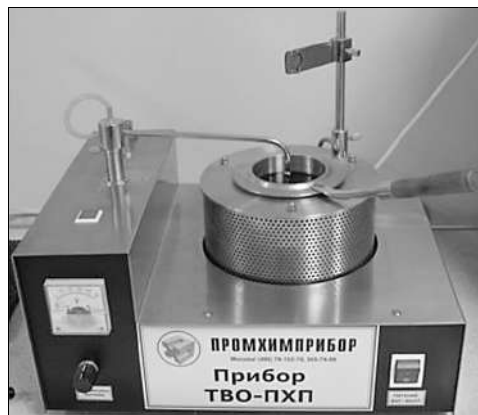
Рис. 4.22. Прибор для определения температуры вспышки в открытом тигле углеводородных жидкостей
