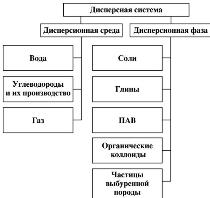
Рис. 2.6. Состав БПЖ с точки зрения коллоидной химии
