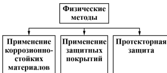
Рис. 8.6. Технологические методы борьбы с коррозией
