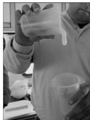
Рис. 4.5. Процесс сшивки полимерного гелирующего агента соединениями бора
