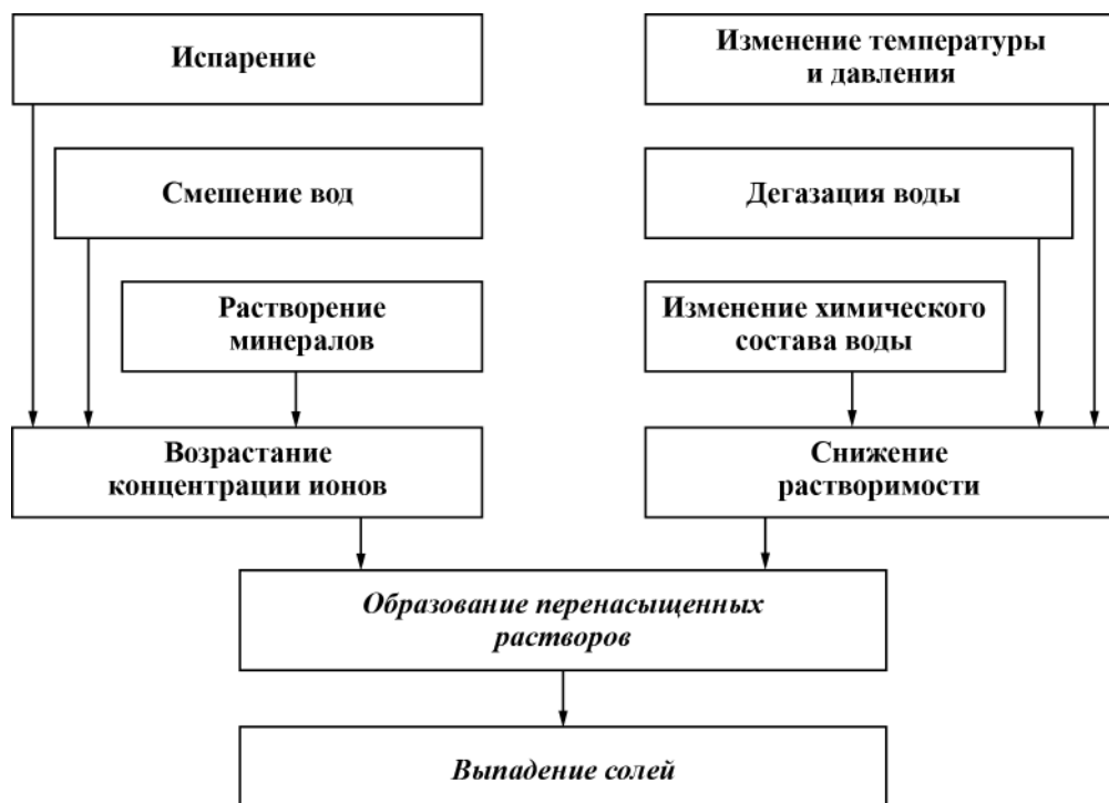
Рис. 8.12. Причины образование отложений солей
