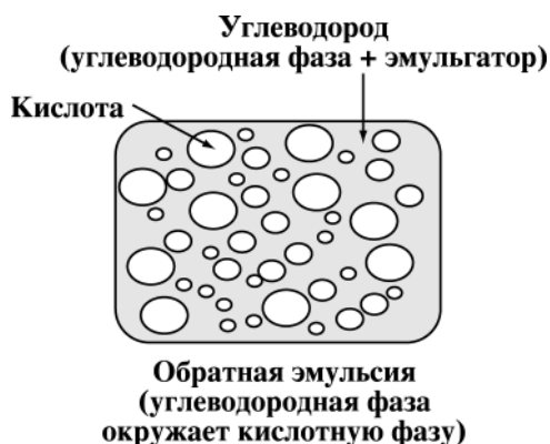
Рис. 5.4. Распределение компонентов в кислотной эмульсии
