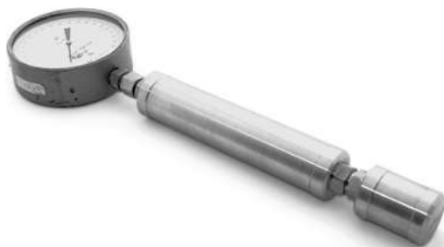
Рис. 4.21. Бомба Рейда для определения давления насыщенных паров углеводородных жидкостей
