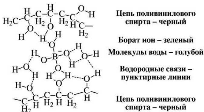
Рис. 4.5. Процесс сшивки полимерного гелирующего агента соединениями бора
