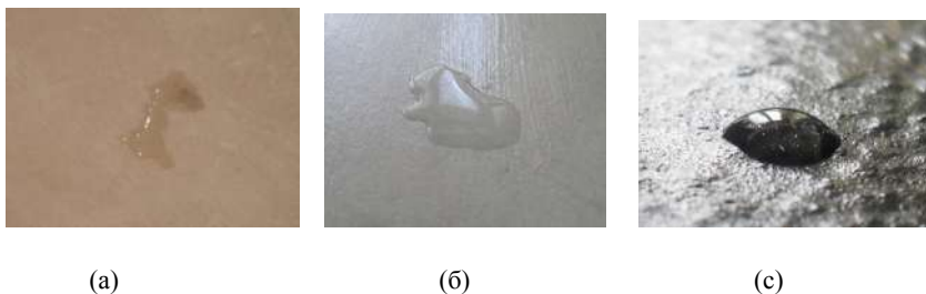
Рис. 66 – Поведение воды на поверхности приготовленных гипсокартонов [138]
