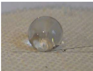
Рис. 58 – Капля воды на чистой ткани (а); капля воды на ткани, обработанной в 70% спиртовом растворе, содержащей супергидрофобную сажу (б)
