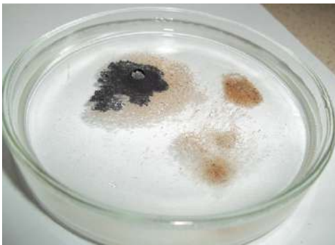
Рис. 69 – Поведение песка на поверхности воды [139]
