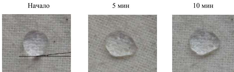
Рис. 61 – Капля воды на отстиранной ткани, обработанной методом Обручева
