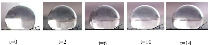
Рис. 40 – Капли жидкости, нанесенные на сажевую поверхность в разных зонах при различных временах контакта поверхности с каплей воды
