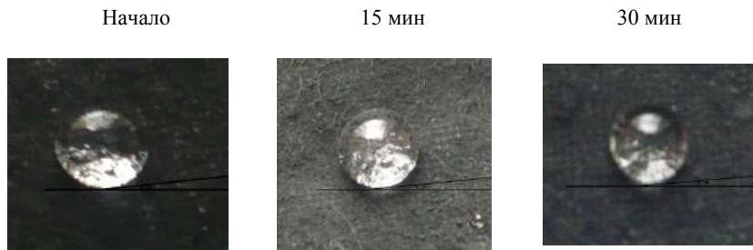
Рис. 62 – Капля воды на отстиранной ткани, обработанной методом Обручева с добавкой сажи обладающей супергидрофобным свойством [137]
