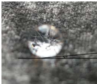
Рис. 58 – Капля воды на чистой ткани (а); капля воды на ткани, обработанной в 70% спиртовом растворе, содержащей супергидрофобную сажу (б)
