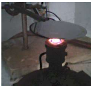
Рис. 35 – Фото процесса осаждения сажи на подложке (а) и температурный профиль по высоте средней части пламени C 3 H 8 /O 2 (б) [123]
