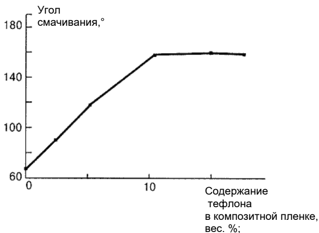
Рис. 22 – Зависимость угла смачивания (вода на поверхности композитной плёнки Ni-тефлон) от содержания тефлона
