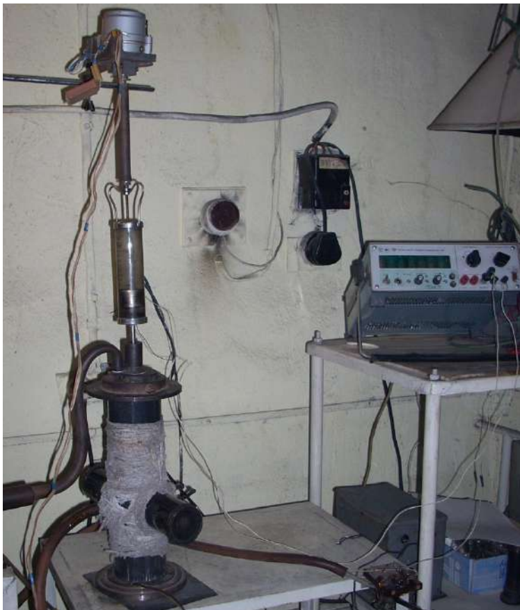
Рис. 6 – Фотография устройства для измерения профиля температуры по высоте пламени
