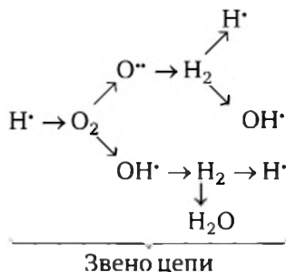
Рис. 4.2. Схема развития цепи в случае разветвленной цепной реакции водорода с кислородом
