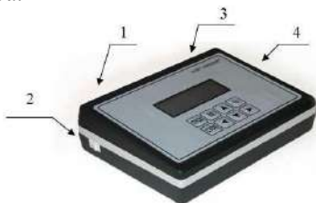
Рис. 1.7. Универсальный контроллер: 1 – сетевой кабель (на задней панели), 2 – тумблер «Сеть», 3 – разъемы подключения модулей и внешнего компьютера (на задней панели), 4 – алфавитно-цифровой дисплей и клавиатура.
