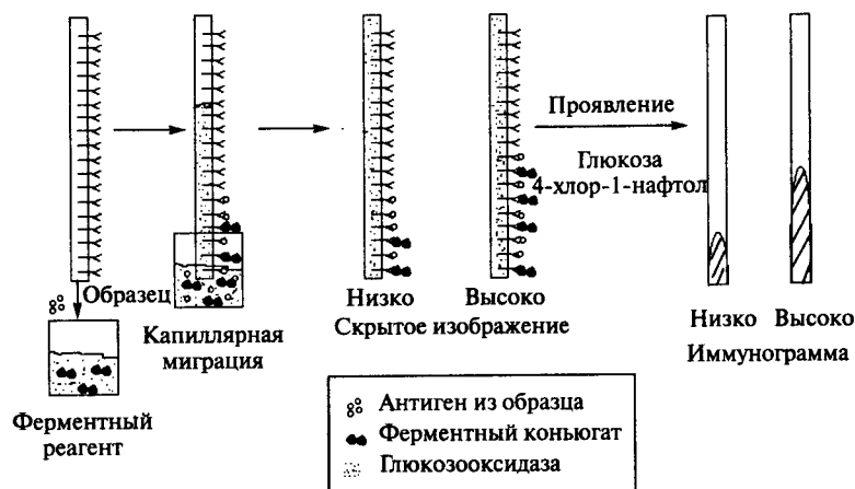
Рис. 3.11. Схема ферментативного иммунохроматографического анализа с применением индикаторных полосок
