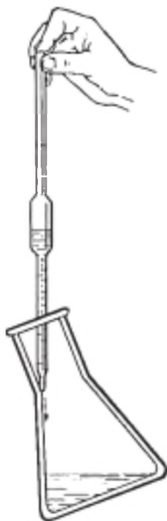
Рис. 16.6. Выливание раствора из пипетки
