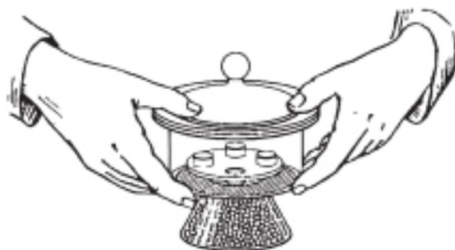
Рис. 2.35. Положение рук при переносе эксикатора
