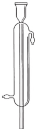
Рис. 2.29. Прямой холодильник (холодильник Либиха)
