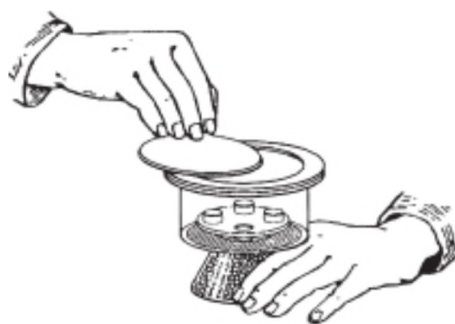
Рис. 2.34. Открывание эксикатора
