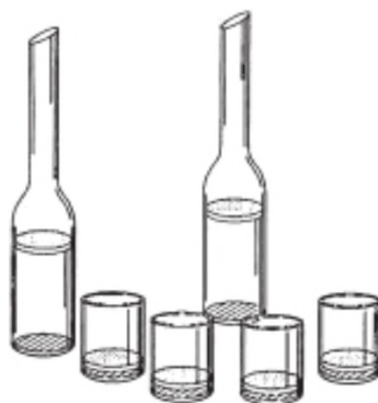
Рис. 15.4. Стеклянные фильтрующие тигли и воронки
