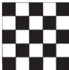
Рис. 3.1. Сокращение лабораторной пробы методом квадратования
