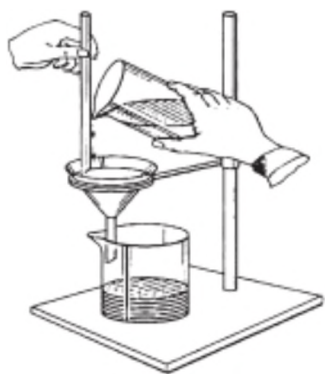
Рис. 15.3. Фильтрование через бумажный фильтр
