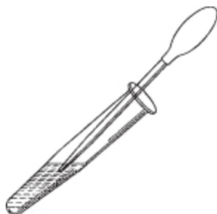
Рис. 2.49. Отделение раствора центрифугата от осадка
