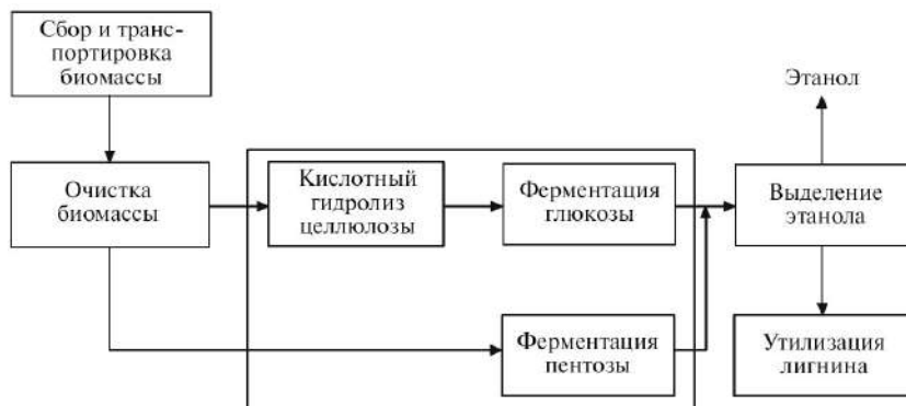
Рис. 2.17. Схема производства топливного (гидролизного) этанола из целлюлозы ферментативным гидролизом
