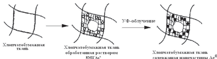
Рис.2.21. Предполагаемая схема образования и фиксации наночастиц серебра в структуре хлопчатобумажных тканей
