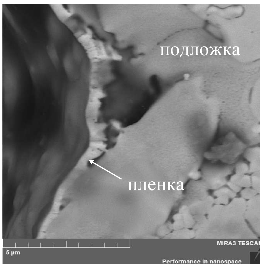
Рис. 3.33. Микрофотография поперечного сечения пленки \text{CaZr}_{0.95}\text{Y}_{0.05}\text{O}_{3-\delta} , осажденной из растворов солей на пористой подложке \text{SrTi}_{0.8}\text{Fe}_{0.2}\text{O}_{3-\delta} , после 5-кратного нанесения раствора [200]
