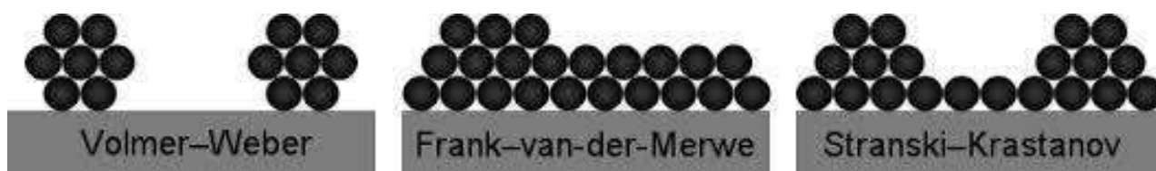
Рис. 2.1. Схема формирования пленки по механизмам Вольмера – Вебера, Франка – Ван-дер-Мерве и Странского – Крастанова
