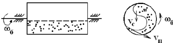
Рис. 12. Схема смешения сыпучих компонентов во вращающемся барабане мешалки
