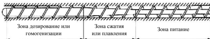
Рис. 22. Разделение шнека на три стадии технологического процесса
