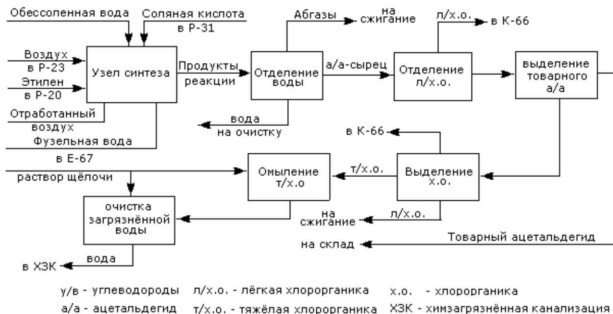
Рис. 8.1. Структурная схема процесса получения ацетальдегида
