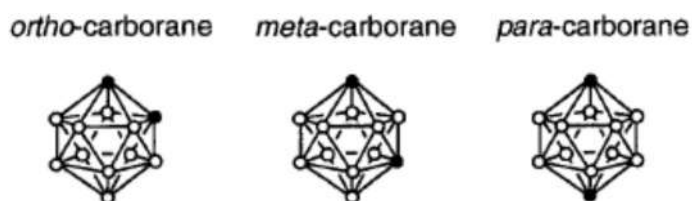
Рис. 4 Строение орто-, мета- и пара-карборанов.
