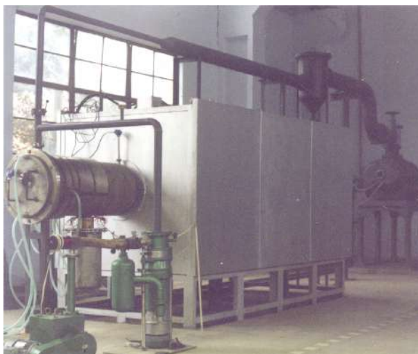
Рис. 6.9. Установка для получения лития с горизонтальным расположением реторты
