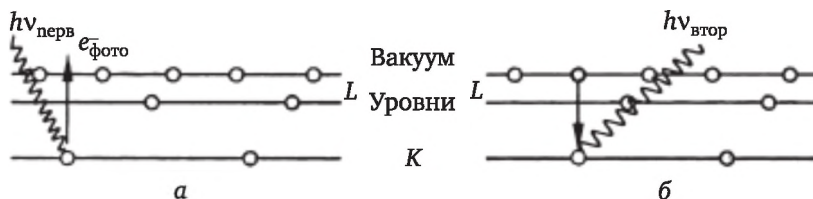
Рис. 23.24. Схема процессов ионизации (а) и возникновения рентгеновского спектра (б)
