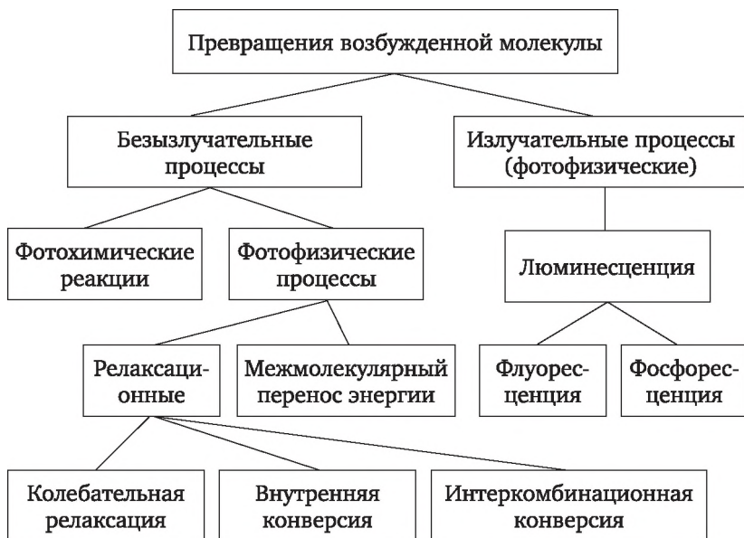
Рис. 4.6. Схема превращений возбужденной молекулы
