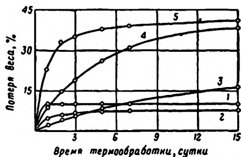
Рис. 98. Термоокислительная деструкция при температуре 400° С полиметилсилоксана, полифенилсилоксана и их сополимеров с полиалюмофенилсилоксаном.
