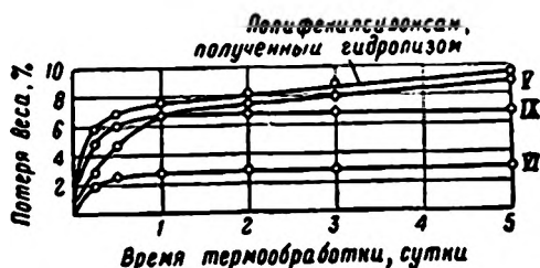
Рис. 94. Потери веса полимеров, полученных реакцией обменного разложения, и полифенилсилоксана при температуре 350°С (обозначения кривых в табл. 59).
