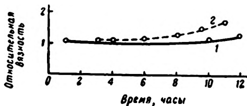
Рис. 57. Зависимость относительной вязкости 10%-ного раствора полимера в бензоле от продолжительности полимеризации при температуре 134° С:
