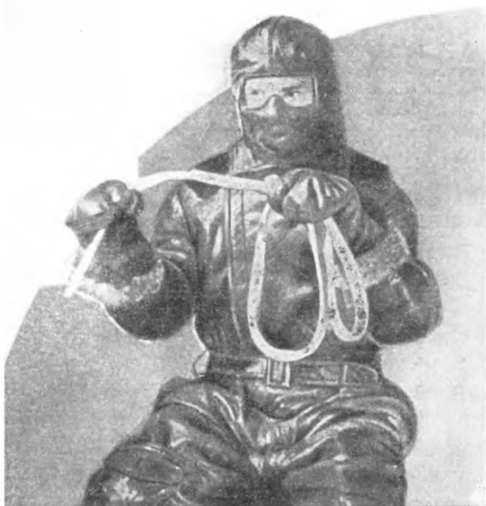
Рис. 5. Кремнийорганический каучук сохраняет эластичность в камере холода при температуре -80^{\circ}
