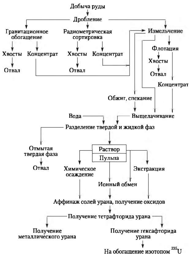
Рис. 4.9. Общая схема переработки урановых руд
