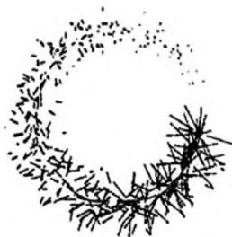
Рис. 5.6. Декорирование спиралевидного дефекта, пронизывающего всю толщину пластины (дефект составлен из отдельных центров адсорбции) радиоактивным зондом ( \alpha -излучателем) в режиме стационарной проницаемости мембраны
