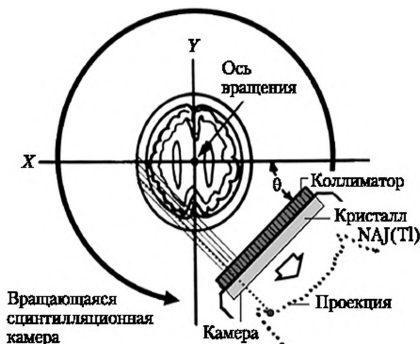
Рис. 7.8. Схема метода однофотонной эмиссионной томографии
