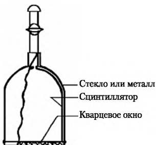
Рис. 6.3. Простейшая сцинтилляционная камера для измерения концентрации радона (ячейка Лукаса)
