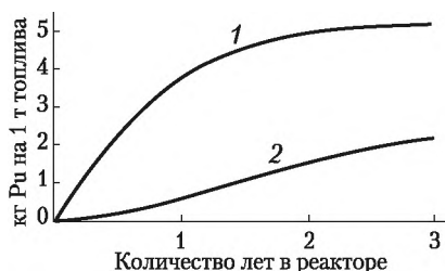
Рис. 2.25. Накопление изотопов плутония в реакторе (изменение изотопного состава от оружейного к реакторному, т.е. к негодному для оружейного использования):
