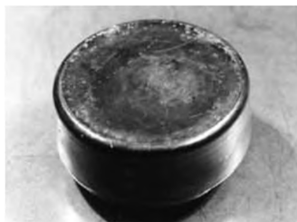
Рис. 2.33. Отливка из плутониево-галлиевого сплава (плутониевый пит) — компонент ядерного заряда
