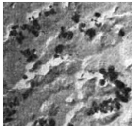
Рис. 1.17. Локализация трития на границах мартенситных пластин в стали (электронно-микроскопическая автораддиография, увеличение \times 20\,000 )
