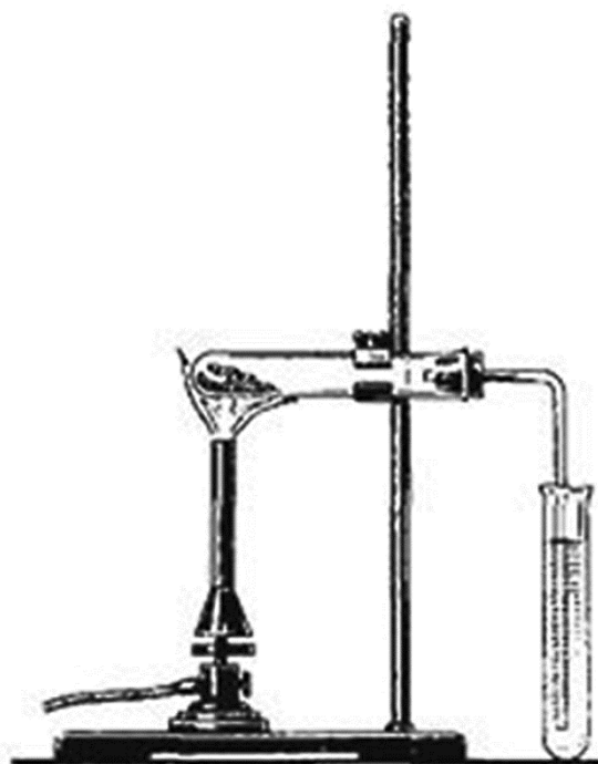
Рис. 5. Восстановление оксида меди (II) углем
