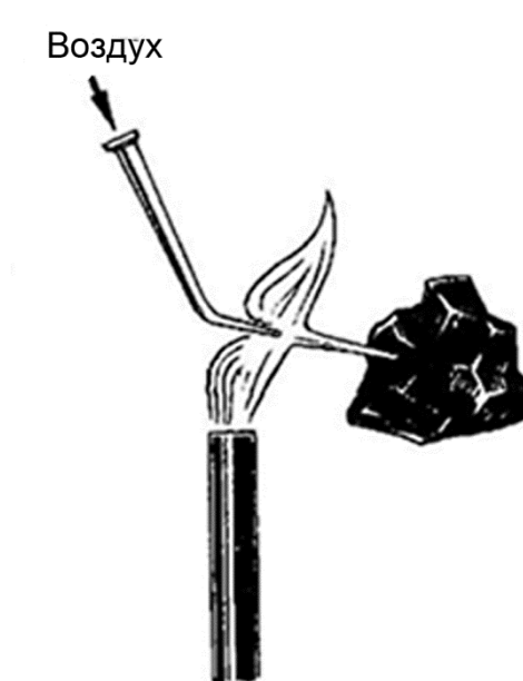
Рис. 20. Восстановление оксидов металлов на куске угля
