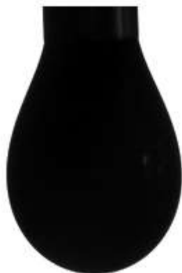
Рис. 17. Изображение висящей капли суспензии бентонита
