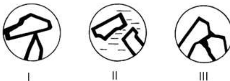
Рис. 12. Основные типы контактов между частицами твердых дисперсных фаз в концентрированных дисперсных системах: I – атомный контакт; II – коагуляционный контакт; III – фазовый контакт
