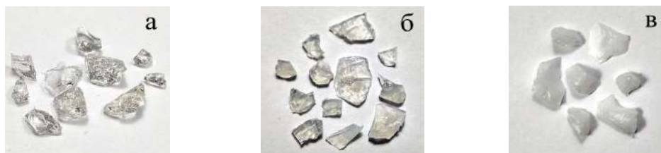
Рис. 3.77. Фотографии биостекол, содержащих 0% (а), 3% (б) и 9% (в) вольфрама
