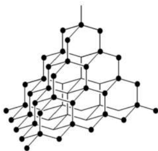
Рис. 6. Схематичное изображение пространственной формы углерода (алмаза) [20]
