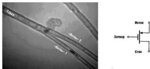
Рис. 103. Y-образный транзистор [366]
