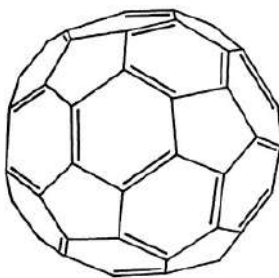
Рис. 21. Структура кластера C_{60} [59]
