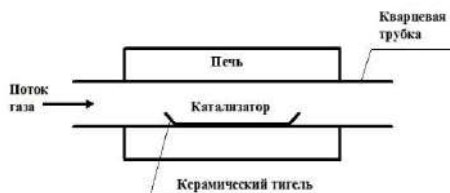
Рис. 88. Схема установки для получения углеродных нанотрубок методом химического осаждения [198]
