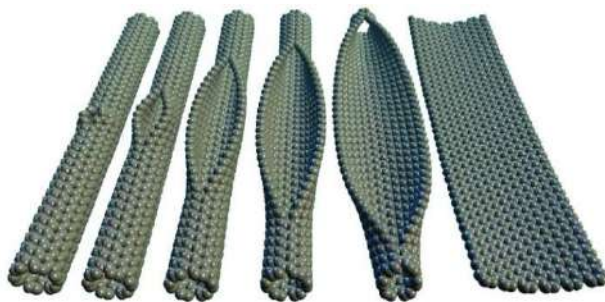
Рис. 128. Образование графеновых нанолент из углеродных нанотрубок: постепенное разворачивание одной из стенок нанотрубки с образованием наноленты [466]
