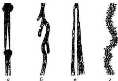
Рис. 68. Морфологические разновидности второго порядка [72]: а - булавообразные нановолокна с периодическим изменением толщины стенок; б - разветвлённые нановолокна; в - нанотрубки, покрытые слоем аморфного углерода; г - нановолокна, покрытые графитовыми чешуйками
