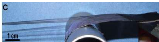
Рис. 95. Фотография получения (наматывания на цилиндр) листа шириной 5 \text{ см} , вытягиваемого из массива («лес») углеродных нанотрубок [349]
