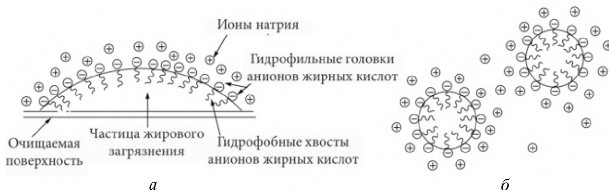
Рис. 18. Механизм удаления жирового загрязнения с помощью мыла
