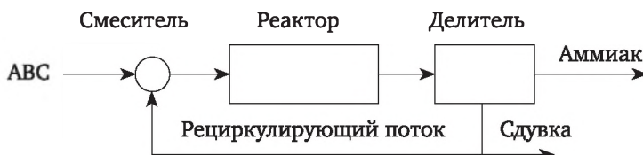
Рис. 5.4. Схема материальных потоков в установке синтеза аммиака
