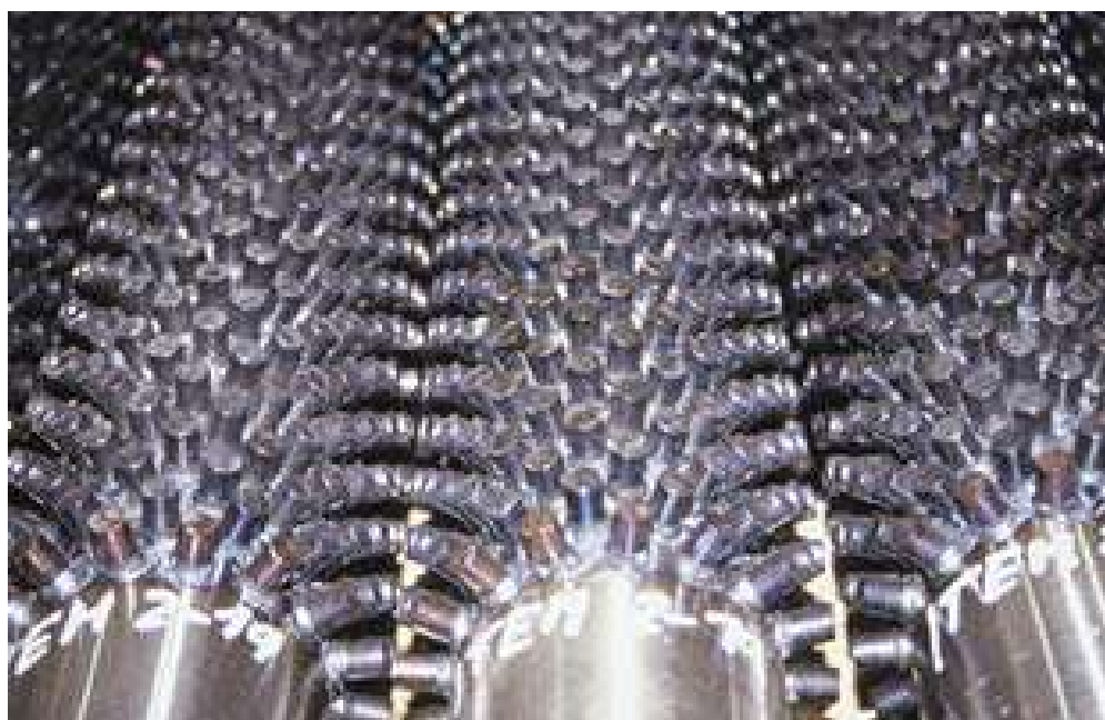
Рис. 6.11. Ошипованная труба: а – по кольцу; б, в – по винтовой линии
