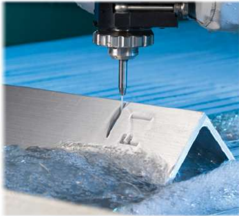
Рис. 4.14. Гидроабразивная резка
