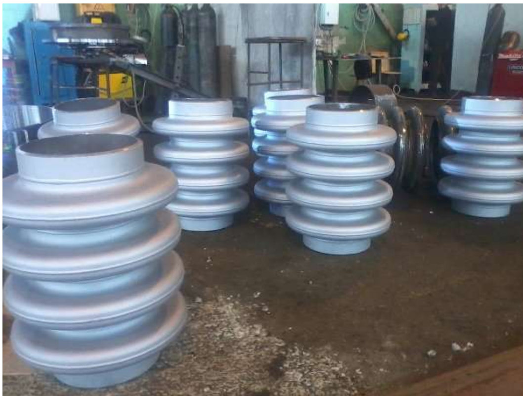
Рис. 5.12. Линзовые компенсаторы
