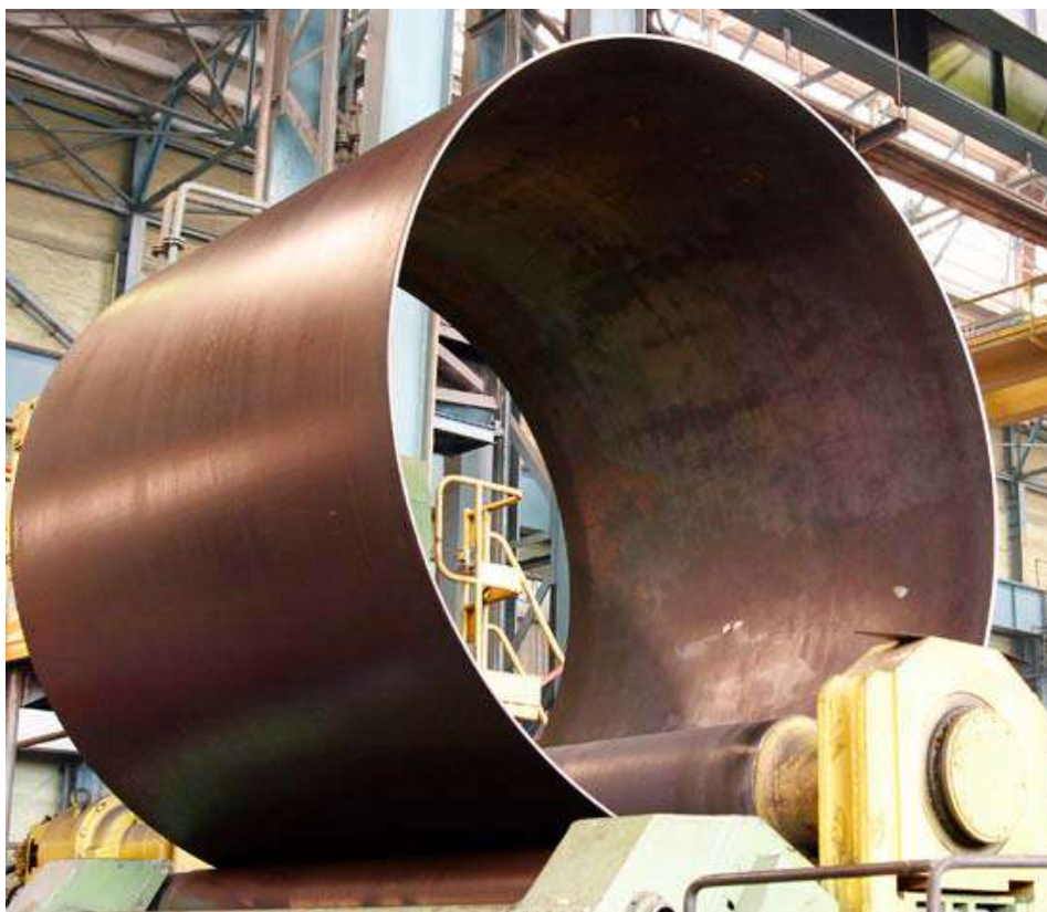
Рис. 4.26. Трехвалковая листогибочная машина
