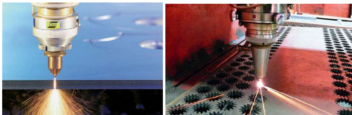
Рис. 4.12. Лазерная резка
