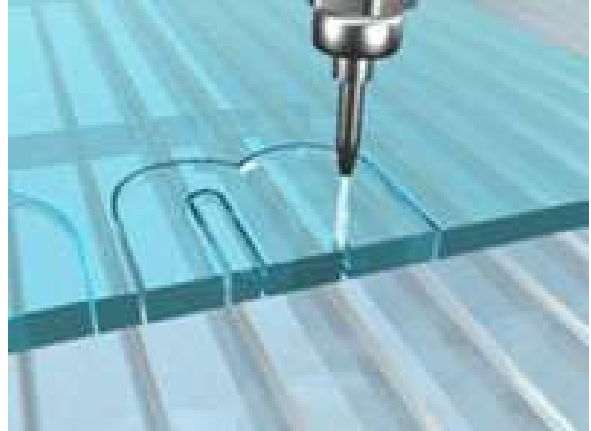
Рис. 4.14. Гидроабразивная резка
