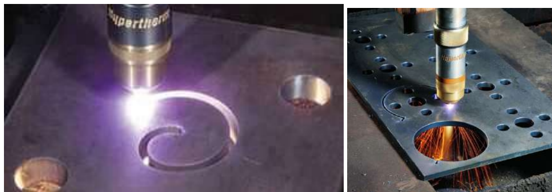
Рис. 4.13. Плазменная резка
