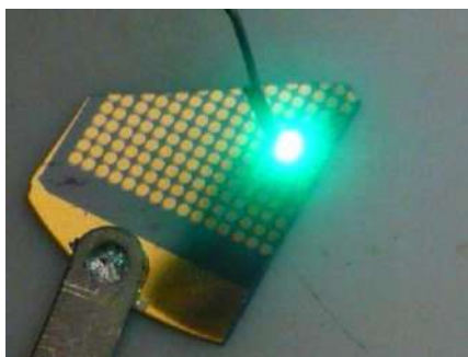
Рис. 70 – Работаящая светодиодная структура на основе GaN, выращенная на темплейте SiC/Si с дилатационными диполями
