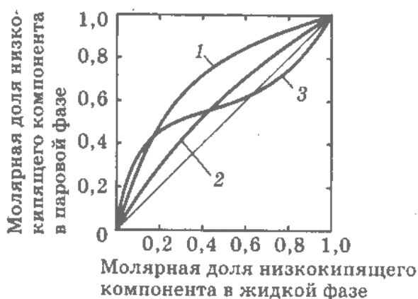
Рис. 20. Состав жидкости и пара в бинарной смеси: идеальный раствор - 1; неидеальный раствор - 2; раствор, сильно отличающийся от идеального и образующий азеотропную смесь - 3.
