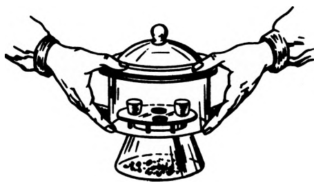
Рис. 4.8. Способ переноса эксикатора
