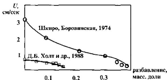
Рис. 5. Зависимость скорости горения Ti+C от разбавления конечным продуктом
