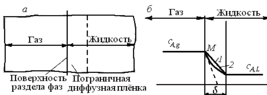
Рис. 7.8. Схема пленочной модели (а) и профиль изменения концентрации растворимого компонента A (б): 1, 2 – соответственно при отсутствии и наличии химической реакции
