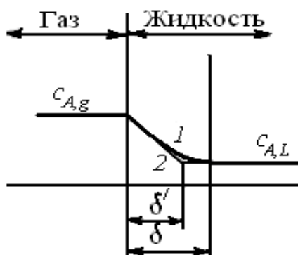
Рис. 7.9. Аппроксимация нелинейного концентрационного профиля при наличии химической реакции: 1 – реальный (нелинейный); 2 – приближенный
