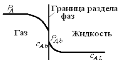
Рис. 7.7. Распределение парциального давления и концентрации растворяемого газообразного вещества A в фазах при массопередаче
